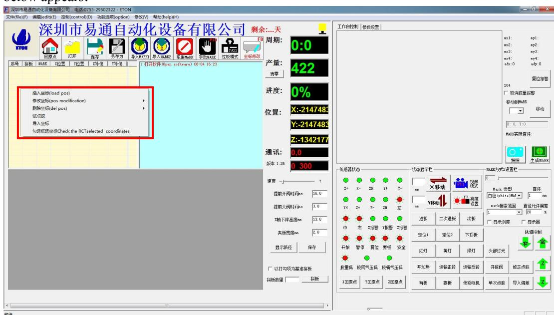
点击插入坐标，即可在生成该点的坐标并显示在坐标显示区
